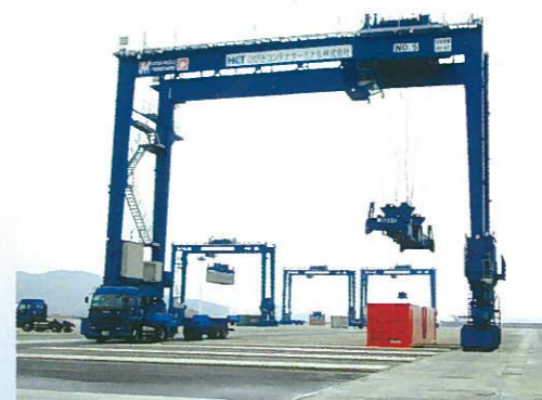
トランスファークレーン
