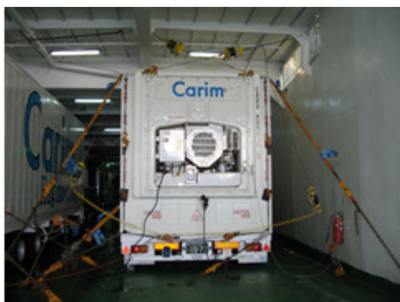
船内での厳重なラッシング
